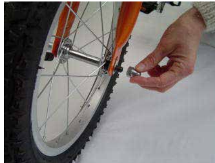
Odkręć i wyjmij nakrętki koła. Zostaw podkładki
