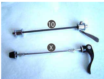
Specjalny szybkozamykacz (10) Standardowy szybkozamykacz (X)
