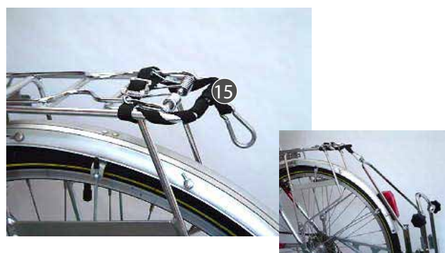
... albo przymocować ją do bagażnika paskiem zaciskowym (15)
