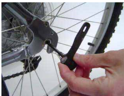
Odepnij szybkozamykacz i usuń go całkowicie.
