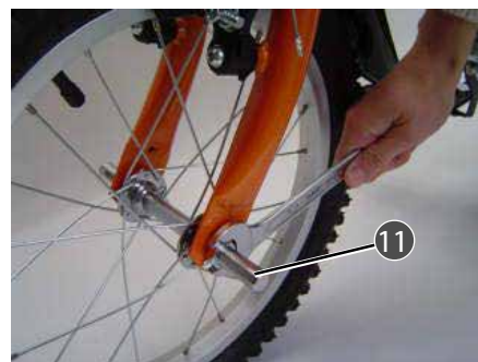
Odkręć i wyjmij nakrętki koła. Zostaw podkładki
