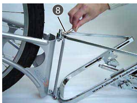
Wyjąć kołek zabezpieczający (8)
